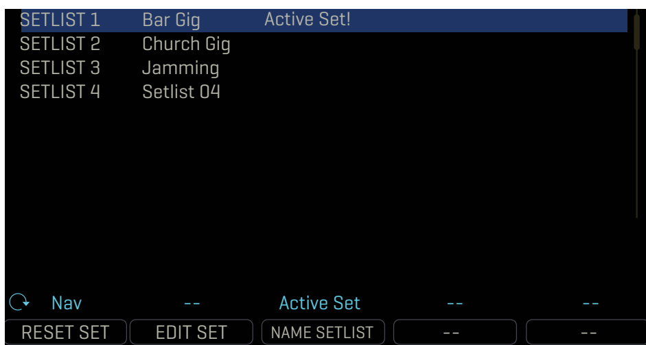
Abb. 3: Die Seite Setlists im Menü Setlists/Songs, auf der du Setlists zum Bearbeiten aufrufen oder die aktive Setlist ändern kannst.
